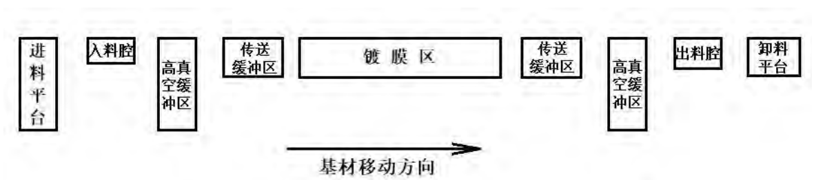
(2) 太阳能集热器（平板王）磁溅射镀膜工艺流程图见图 3-2:
